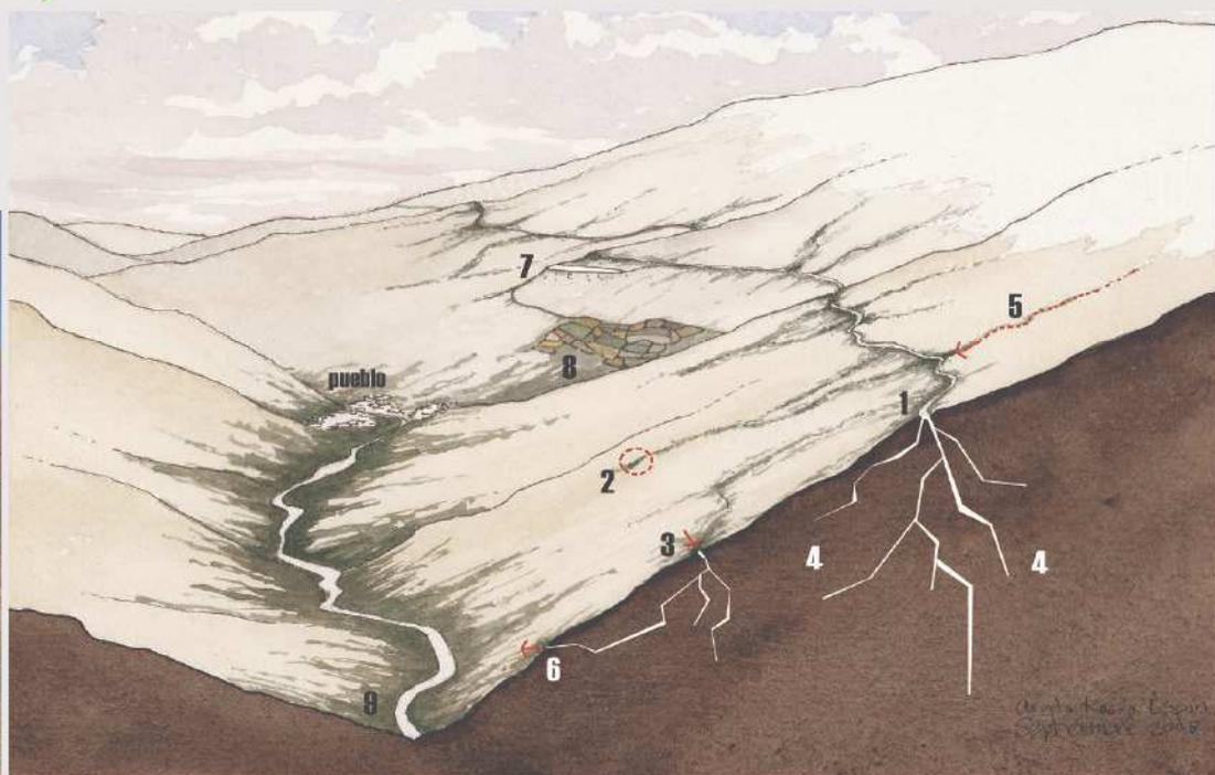
FUNCIONAMIENTO DE UNA ACEQUIA DE CARED: 1. acequia; 2. infiltración en la roca alterada; 3. infiltración a través de fisuras; 4. flujo subterráneo profundo; 5. surgencias (remanentes); 6. fuentes; 7. balsas; 8. regadíos; 9. río
