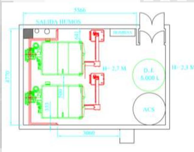
Parking- 1: Sala de Calderas
