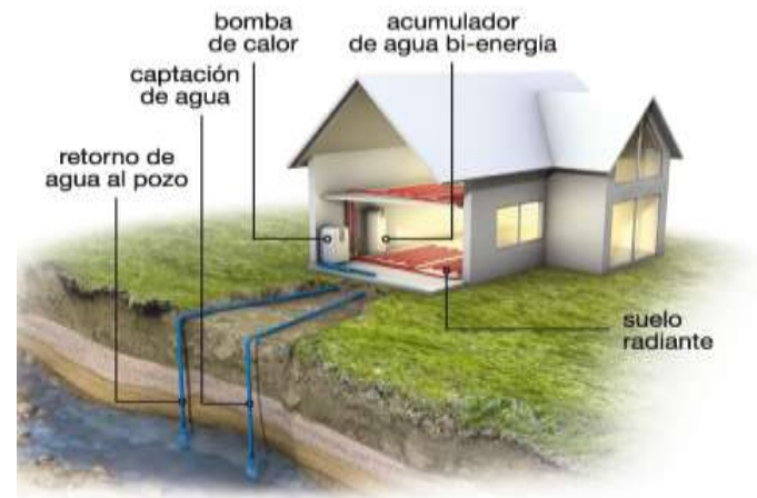
Sondeos de captación de agua someros
