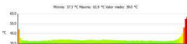
Análisis Termográfico de luminaria superficial
