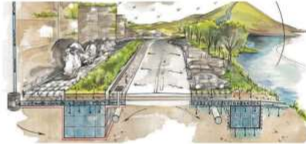
Incorporación de pavimentos permeables a través Sistemas Urbanos de Drenaje Sostenible (SUDS)
